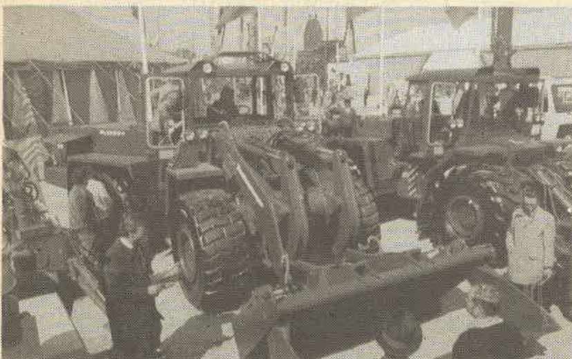
Ein zukunftssträchtiger Produktionsbereich – militärisches Gerät? Hier der IBH-Zettelmayer Radlader ZL 3000 F (255 PS, 90 kmh schnell), von dem 1980 158 Stück an die französische Armee geliefert wurden!
